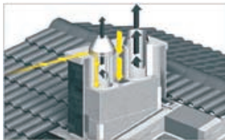
slika 5 Prerez skozi izvedbo zaključka LAS dimnika Schiedel Absolut 18 TL 12 s »termo« jaškom
